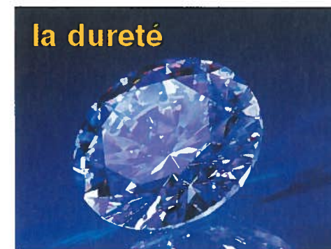
Figure 4.10 La dureté indique le degré de résistance d'une matière aux égratignures ou aux bosselures permanentes. Le diamant est la matière naturelle la plus dure sur la Terre. C'est pourquoi on utilise des foreuses à pointe de diamant pour percer d'autres matières dures, comme la roche et l'acier.
